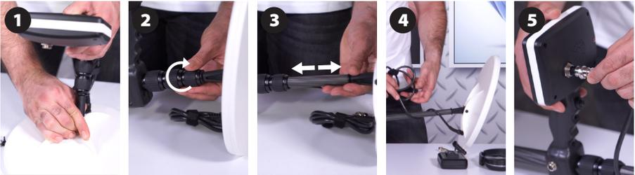
Installez la vis en plastique qui relie le panneau inférieur de la bobine de recherche, puis serrez-la suffisamment pour stabiliser la plaque en place
