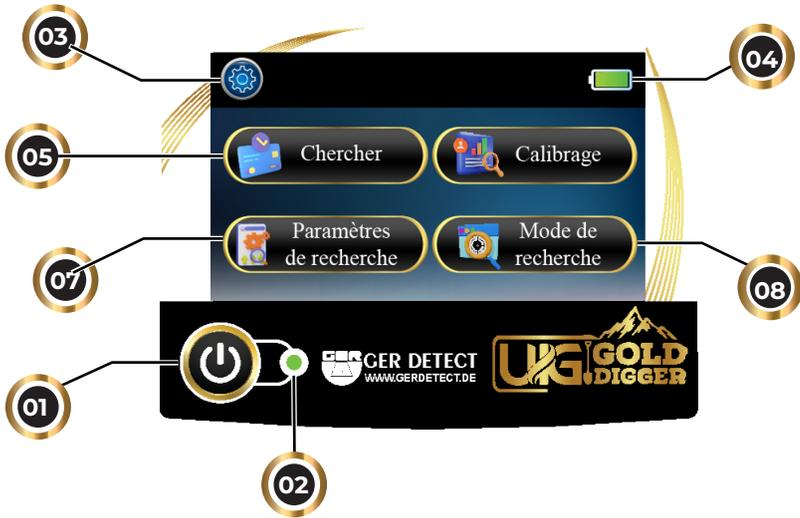
**1- Bouton d'alimentation :** allumez l'appareil en appuyant sur le bouton ON/OFF pendant deux secondes.
