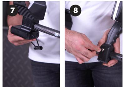
Tenez l'appareil horizontalement, allumez-le en appuyant sur le bouton ON/OFF pendant deux secondes, puis porter l'appareil en mode de recherche.
