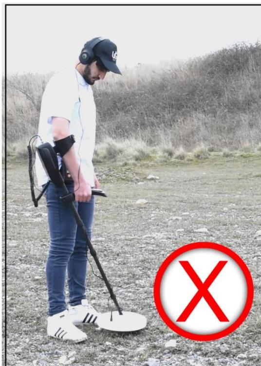
Eviter le frottement continu de la bobine avec le sol et les roches.
