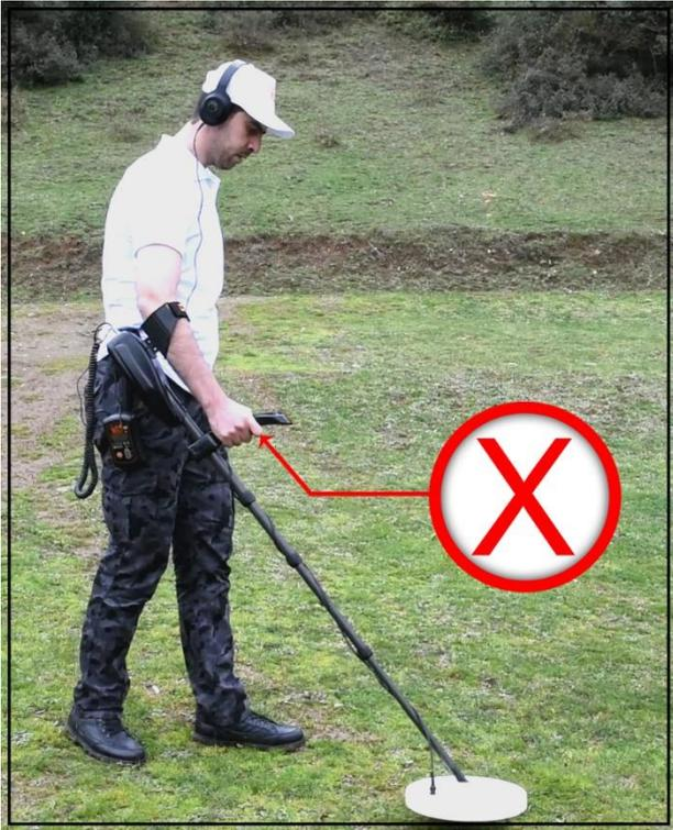
**Notez:** Ne cliquez pas sur le bouton d'etalonnage quand l'appareil est cours de fonctionnement.
